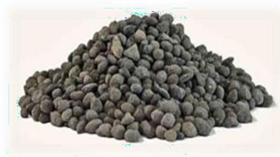
**Figure 07 :** Aspect du produit semi fini clinker
